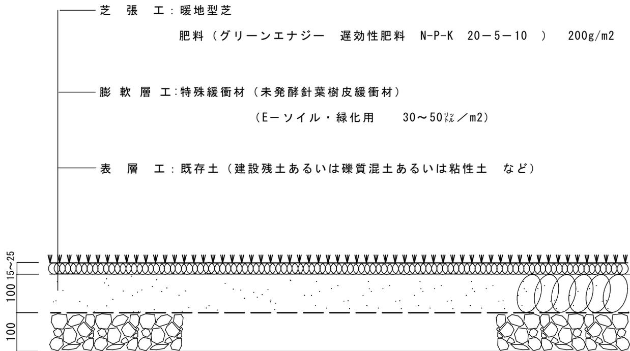
大林式緑化II型工法（残土利用型）断面図 S=1/10
